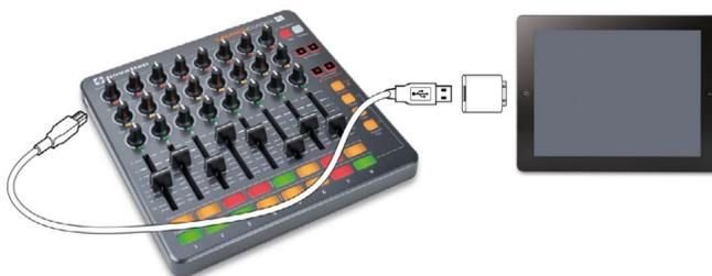
Nota: Para usar Launch Control XL con un iPad, debe cambiarlo al modo de bajo consumo. Para hacer esto, mantenga presionados los botones User y Factory Template e inserte el cable USB. Suelte los botones de plantilla y presione 'Record Arm'.\* Finalmente, presione el botón de flecha derecha.
